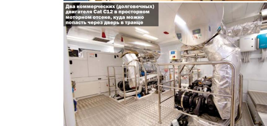
Два коммерческих (долговечных) двигателя Cat C12 в просторном моторном отсеке, куда можно попасть через дверь в транце
